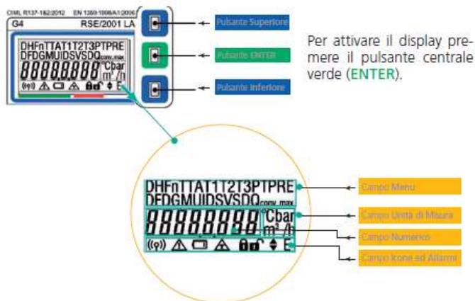
All'attivazione verrà eseguito un test del display, al termine del quale verrà visualizzato il menù con il totalizzatore dei volumi alle condizioni di riferimento.
